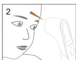
2. Поднесите термометр ко лбу и зажмите кнопку примерно на 1 секунду. Термометр подаст звуковой сигнал и отобразит точную температуру. Если нужно измерить температуру несколько раз подряд, подождите, пока не начнет мигать надпись «--- ° С».
